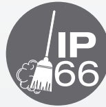
Beskytter mod faste fremmedlegemer og direkte kontakt
