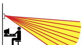
PIR placeret i en højde på 2,0-2,3 m
