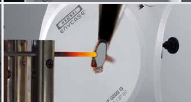
Brandkarakteristika glødetrådtest 960 °C Høj slagfasthed IK 09 (10 joule)
