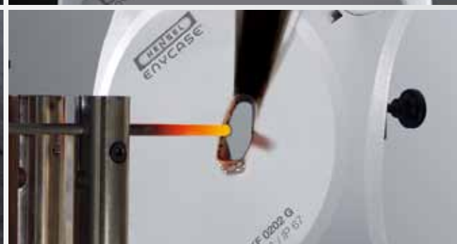
Brandkarakteristika glødetrådtest 960 °C Høj slagfasthed IK 09 (10 joule)
