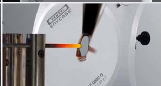
Brandkarakteristika glødetrådtest 960 °C Høj slagfasthed IK 09 (10 joule)
