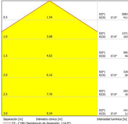
Separación [m] Diámetro cónico [m] Intensidad luminosa [lx]
