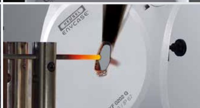
Brandkarakteristika glødetrådstest 960 °C Høj slagfasthed IK 09 (10 joule)
